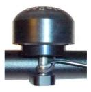
Verlegen Sie nun das weitere Kabel entlang des Lenkers und der Gabel bis zum Dynamo. Den Anschluss an den Dynamo entnehmen Sie dem Kapitel 1.2.
