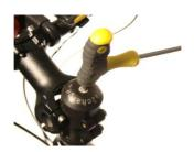
Bevor Sie die Inbusschraube festziehen, drehen Sie den Kopf so, dass die USB-Buche gut zugänglich ist.
