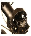
Befestigen Sie den neuen Ladekopf mit der mitgelieferten Inbusschraube. Achten Sie darauf, dass Sie das Kabel nirgends eingequetscht wird.
